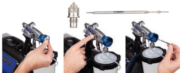
1. Retire la boquilla y el cabezal de aire de la parte delantera.
